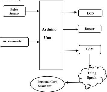
Fig: 3 Block Diagram
